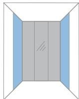
4 Задние углы с зеркальной отделкой, стеклянная задняя стена
