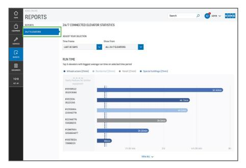
Лифты, подключенные к системе KONE 24/7 Connected Services, позволяют получать информацию о том, как долго оборудование находится в эксплуатации и сколько запусков было произведено за определенный промежуток времени.
